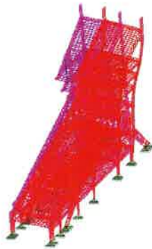
Figura 29 – Modo de vibração na FN de 1,67 Hz
